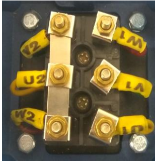
Рис.3. Соединение обмоток мотора по схеме «звезда»
