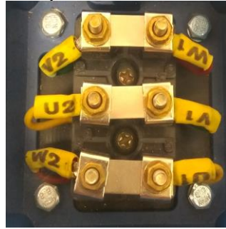
Рис.4. Соединение обмоток мотора по схеме «треугольник»
